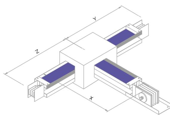
Рис. 7 Горизонтальная Т-образная секция
