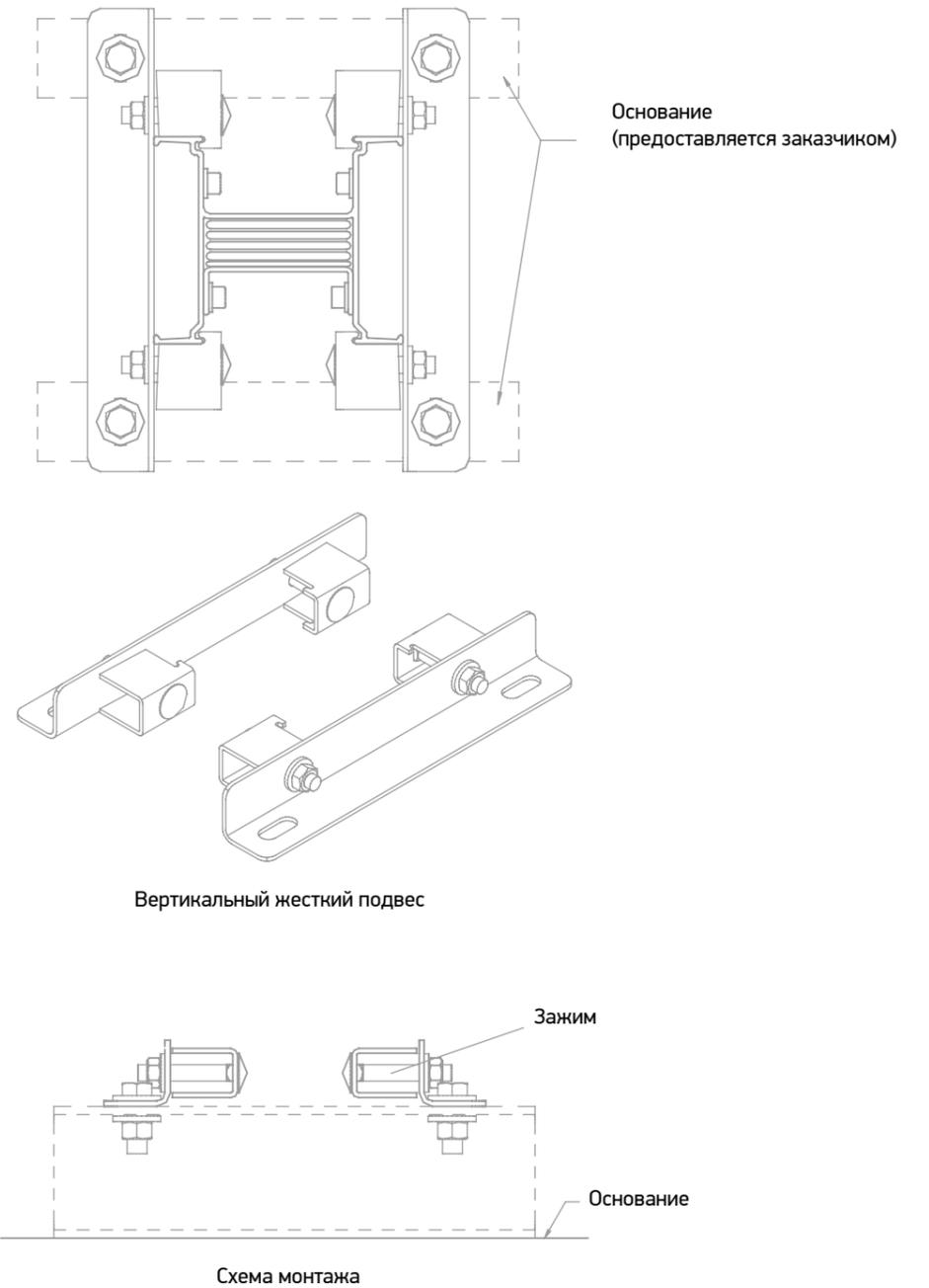
Рис. 24 Монтаж с использованием вертикального жесткого подвеса
