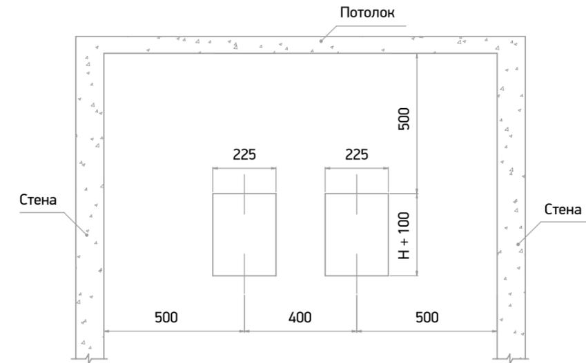
Рис. 19 Рекомендуемые размеры отверстий под шинопроводы в стене
