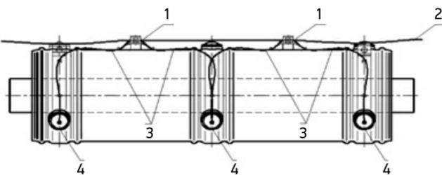
Рис. 26 Устройство системы контроля изоляции
