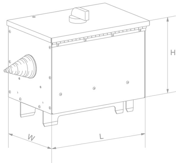
Рис. 15 Габаритные размеры коробки отбора мощности
