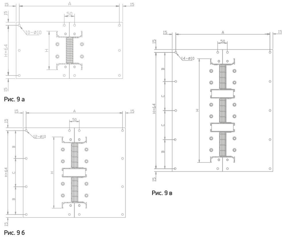
Рис. 9 Габаритные размеры присоединительной секции: а) один пакет шин б) два пакета шин в) три пакета шин
