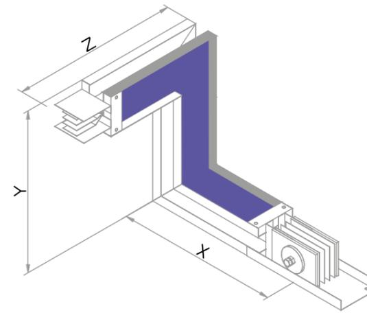
Рис. 5 Угол комбинированный
