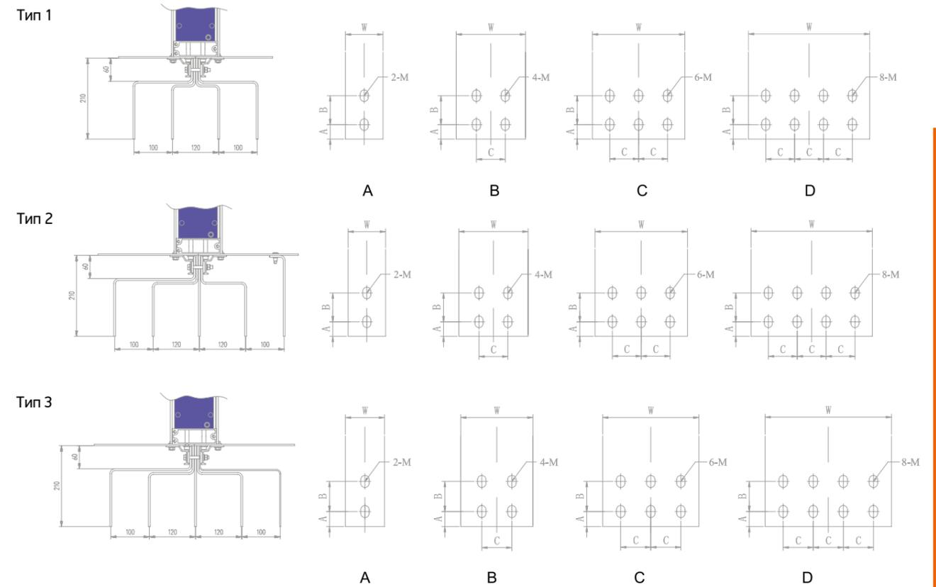
Рис. 10 Присоединительные размеры контактных площадок присоединительных секций
