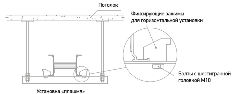
Рис. 21 Горизонтальная установка шинопроводов (потолочный подвес) «плашмя»
