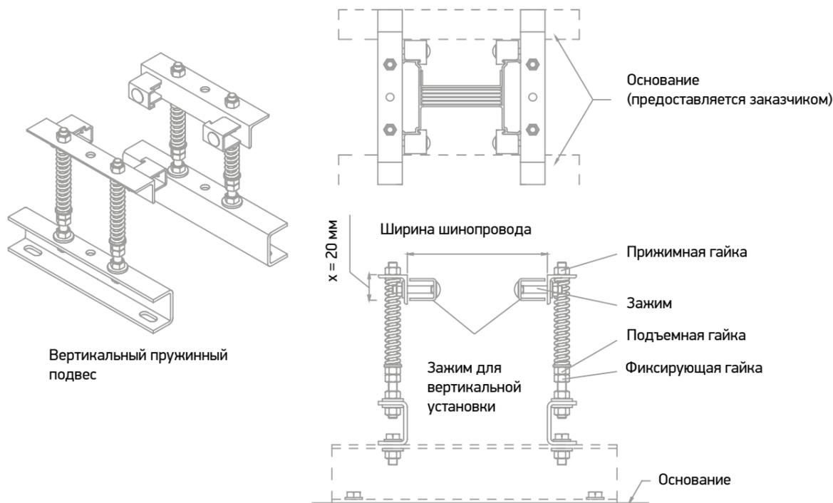
Рис. 23 Монтаж с использованием вертикального пружинного подвеса
