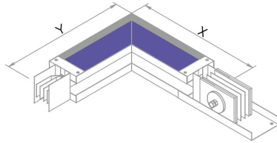
Рис. 4 Угол горизонтальный
