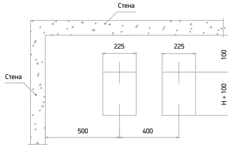
Рис. 22 Рекомендуемые размеры отверстий под шинопроводы (вертикальное перекрытие)
