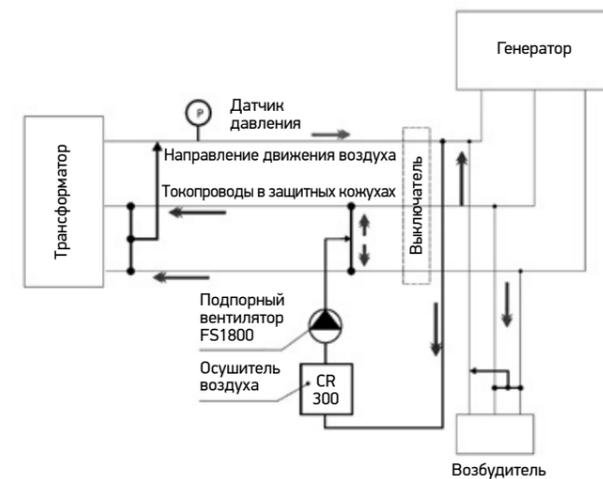
Рис. 27 Схема подключения системы наддува к генераторным токопроводам
