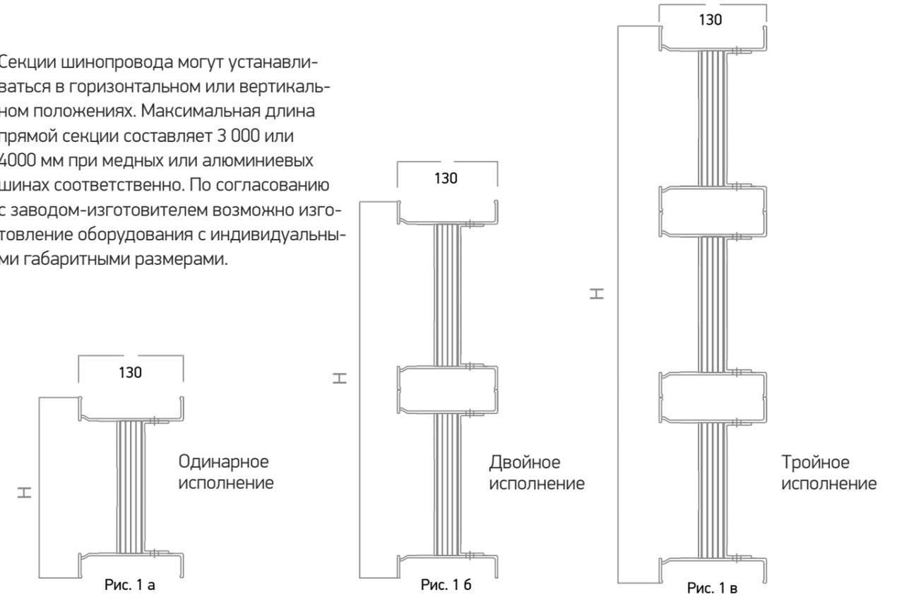
Рис. 1 Варианты исполнения шинопровода в зависимости от номинального тока: а) с одним пакетом; б) с двумя пакетами; в) с тремя пакетами
