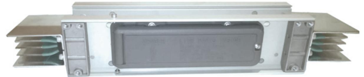
На прямой секции шинпровода может быть расположено различное количество розеток отбора мощности с обеих сторон. На каждой стороне стандартной прямой секции длиной 3000 мм можно установить не более 5 розеток. Заказчик может предусматривать дополнительные розетки для отбора мощности для расширения системы в будущем, при изменении нагрузки или режима работы шинпровода. Конструкция розетки в открытом положении предотвращает касание пальцами токоведущих частей (IP2X).
