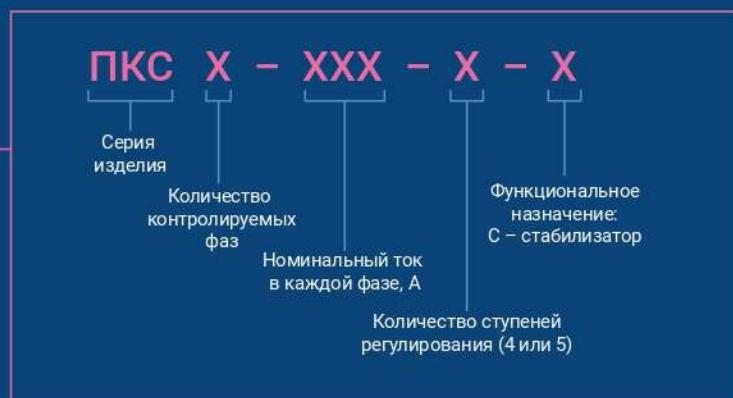
Стабилизаторы «ПКС» изготавливаются в соответствии с ТУ 27.12.31-002-53991775-2020. Пример записи стабилизатора напряжения серии «ПКС» при заказе и в технической документации: ПСК-3-100-5С - Стабилизатор напряжения трехфазного исполнения с номинальным током 100 А, пятиступенчатый.
